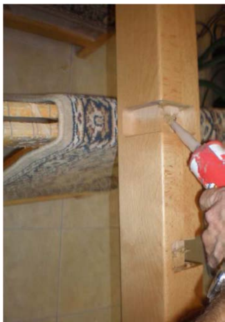
26b. Ausfräsung Pfosten einstreichen
